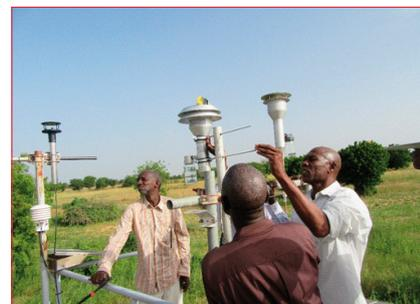
Mise en place d'une tête de prélèvement PM10 pour la collecte sur filtre des aérosols à la station de Bambey.
