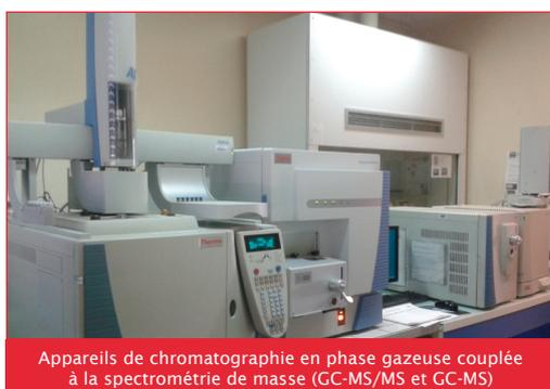
Appareils de chromatographie en phase gazeuse couplée à la spectrométrie de masse (GC-MS/MS et GC-MS)
