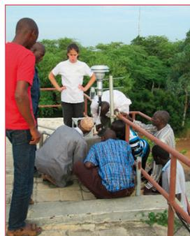
Exercice de mise en place et de récupération de filtres nuclépore dans les préleveurs « on-line » pour la collecte des aérosols.
