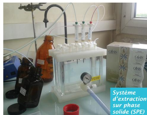
Système d'extraction sur phase solide (SPE)
